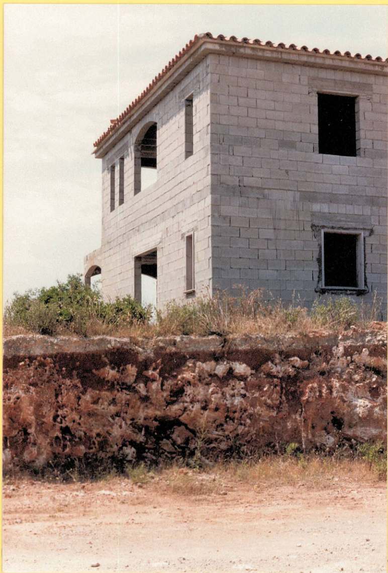
Foto 25. Aspecto de las calizas T_2 de la Zona III_2 . Observese el importante % de oquedades rellenas por limos de tonos rojos.
